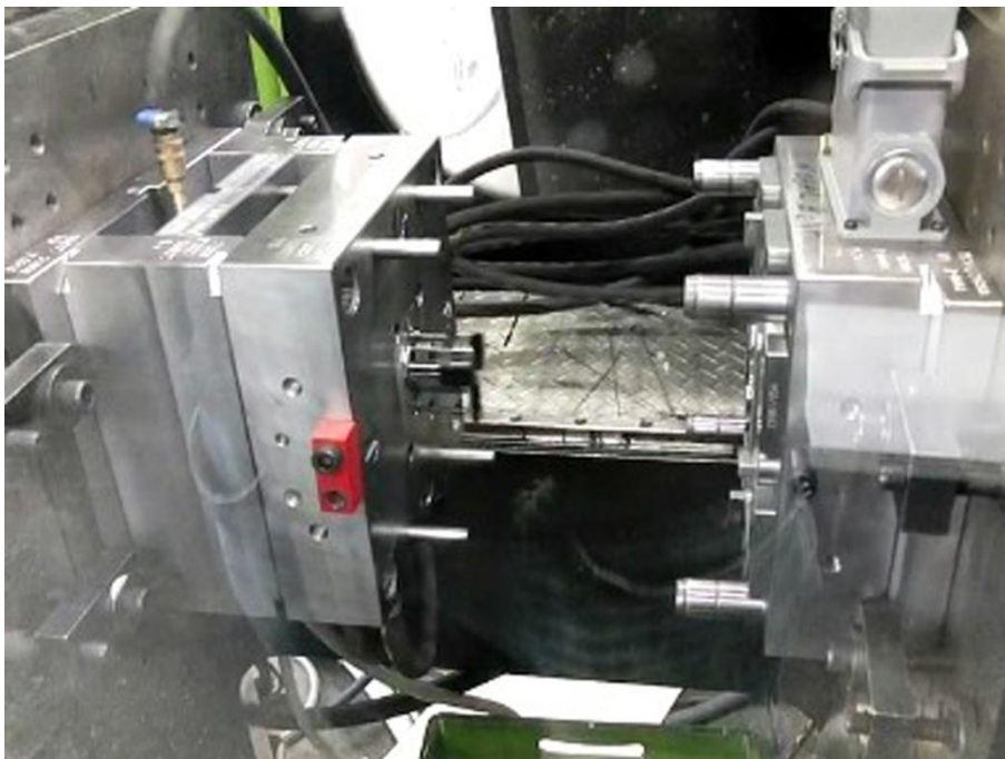
Bild 2: Praktische Versuche mit einem durch Künstliche Intelligenz ausgelegtem Temperiersystem. (Quelle: IPH / Siegfried Hofmann GmbH)
